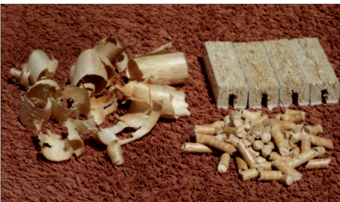
Abb. 11: Holzspäne werden zu Platten oder Pellets
